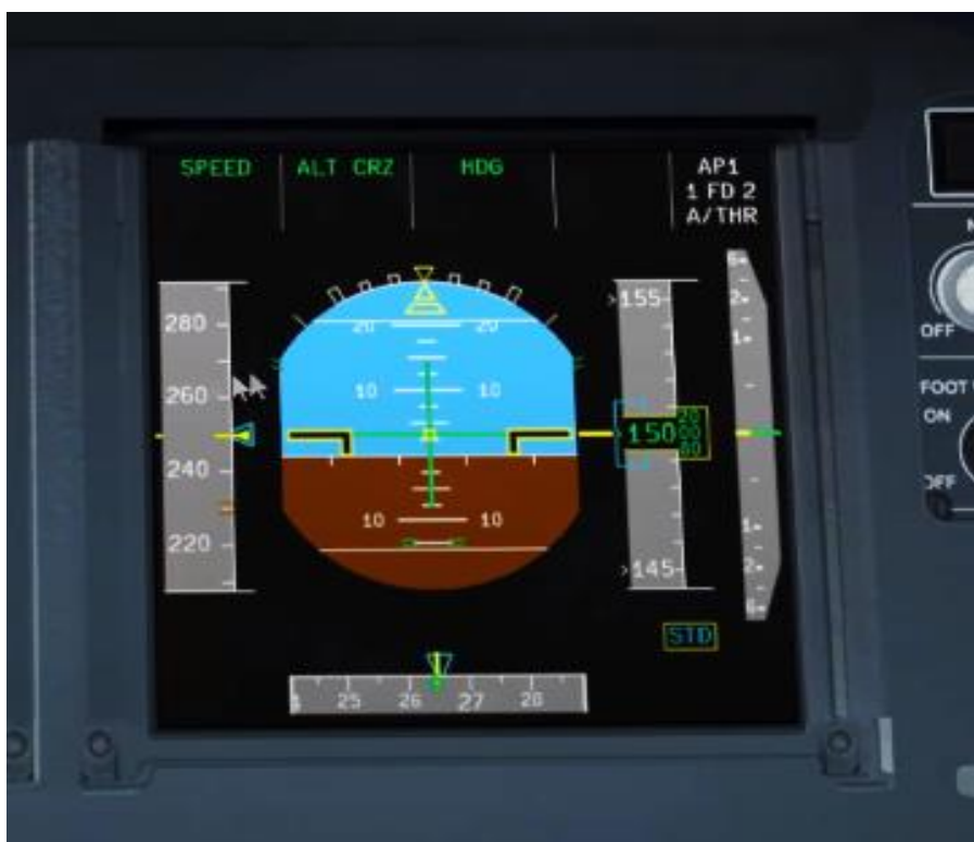
Рисунок 5 – Контроль воздушных и инерциальных параметров пилотажной информации ВС на индикаторе PFD процедурного тренажера «FAROS A-320»
