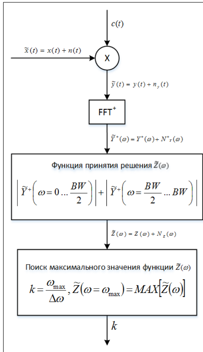
Рисунок 10 – Возможная блок-схема алгоритма обработки сигнала LoRa
