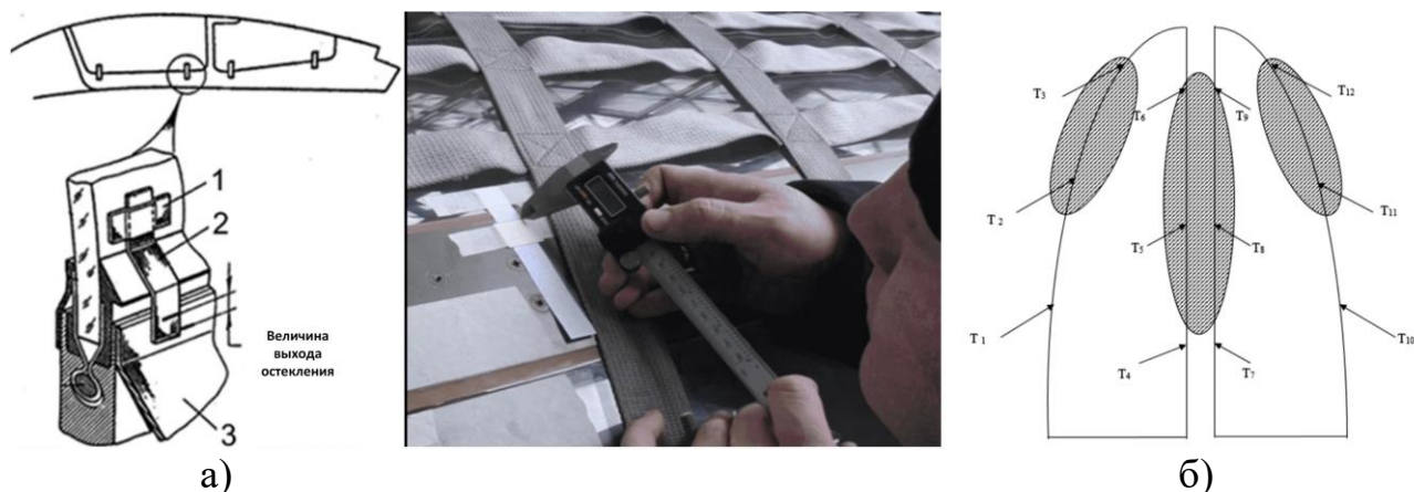
1 – липкая лента, 2 – бумажная полоска, 3 – каркас фонаря; T_1 - T_{12} – места установки бумажных индикаторов
