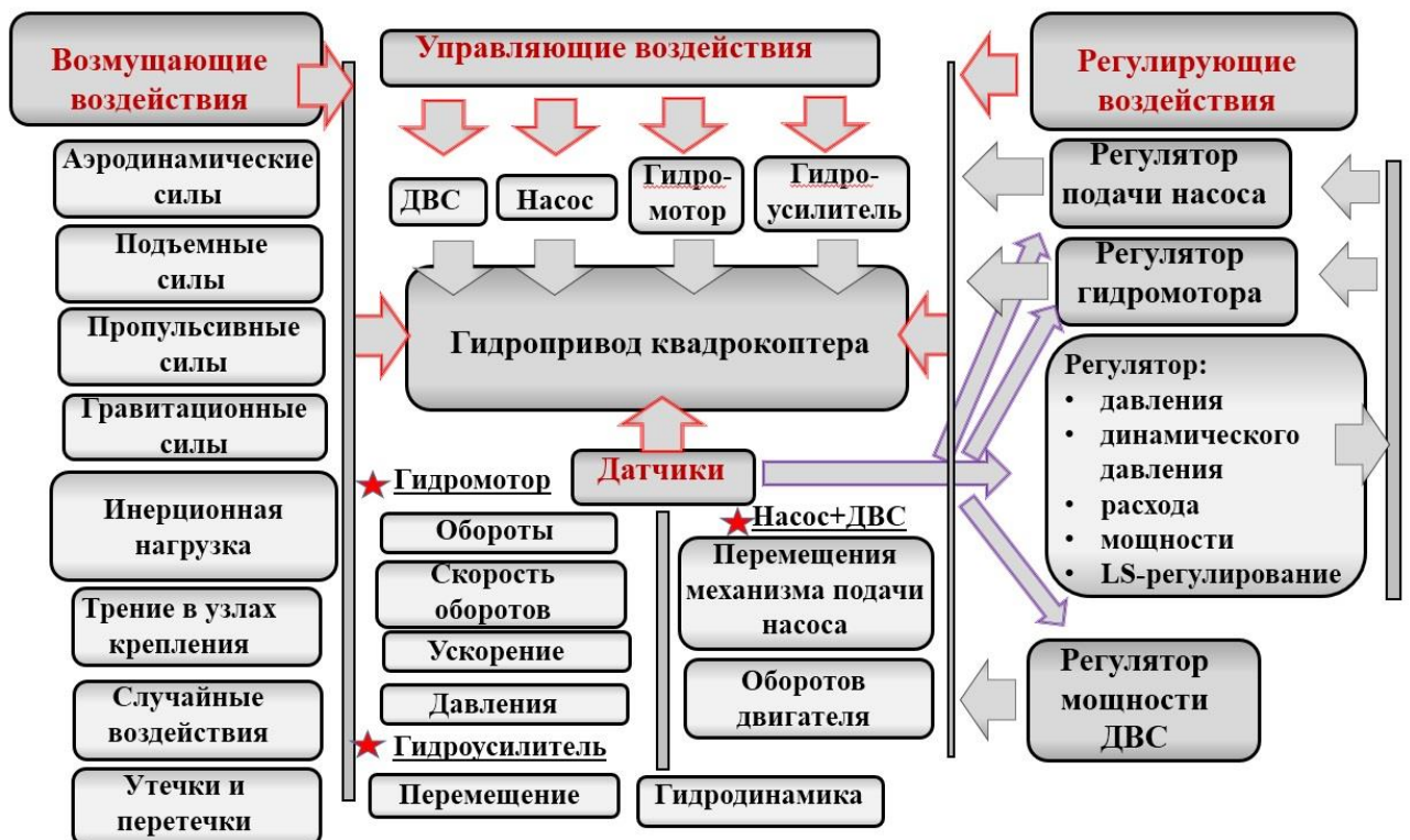
Рисунок 6 – Гидропривод квадрокоптера как объект регулирования
