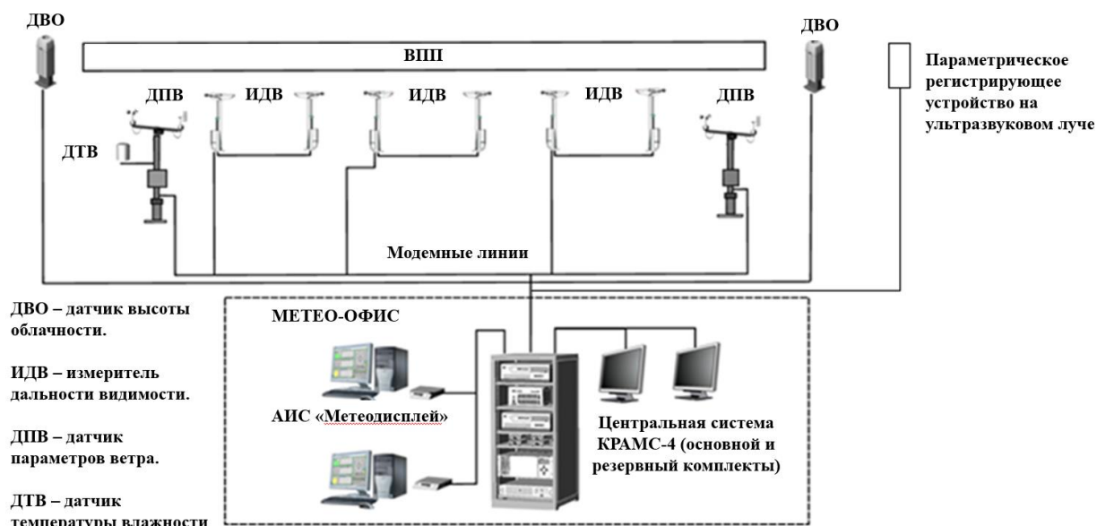
Рисунок 5 – Структурная схема станции КРАМС с базовым набором датчиков, дополненная параметрическим регистрирующим устройством на ультразвуковом луче. Источник: составлено на основе «Комплексная радиотехническая аэродромная метеорологическая станция «КРАМС-4» // [Электронный ресурс]. URL: http://iram.ru/iram/all_main.php?js=1&list_par=20-0
