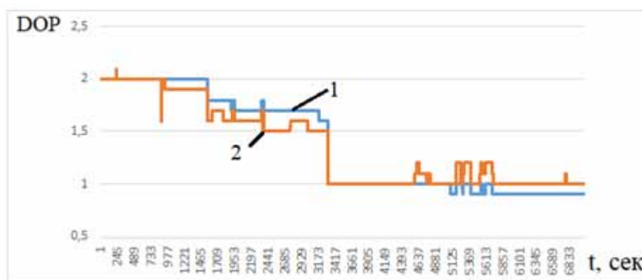
Рисунок 6 – Графики изменения горизонтального и вертикального ГФ
