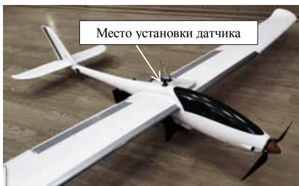
Рисунок 1 – Место установки датчика GY-91
