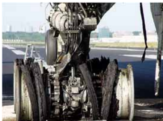
Рисунок 2 – Последствия разрушения пневматика [rikabu.ru]
