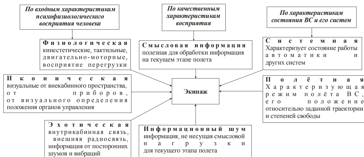
Рисунок 1 – Классификация источников информации, воспринимаемых пилотом в полёте
