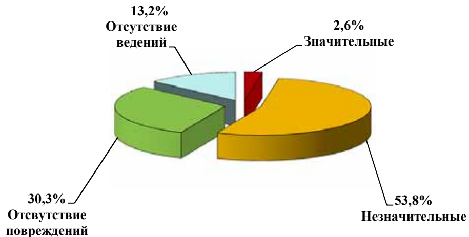
Рисунок 4 – Структура повреждений ВС вследствие ударов обломков шин
