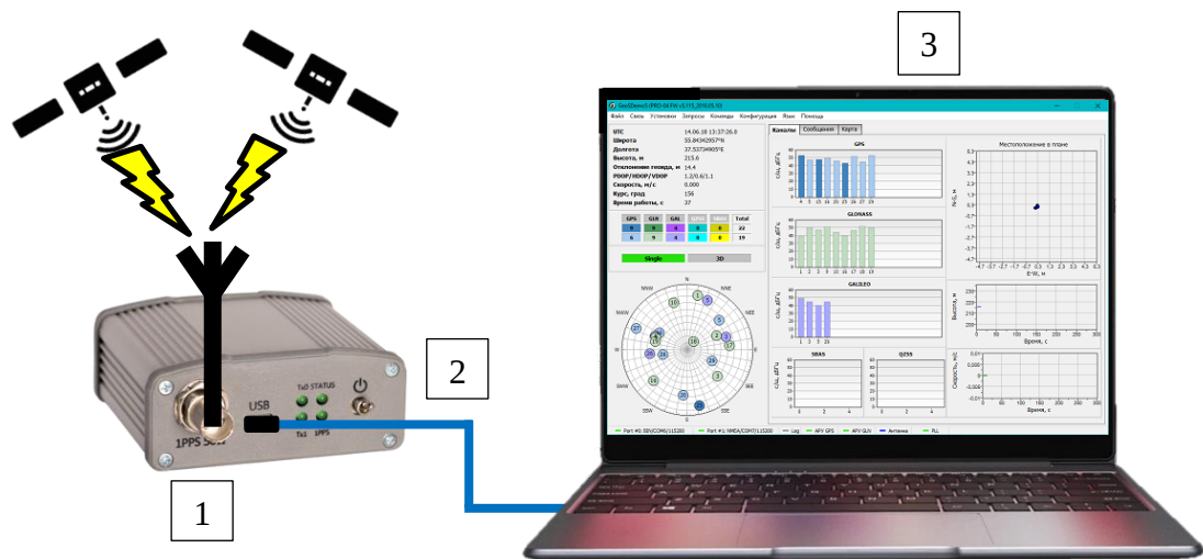
Рисунок 5 – Схема экспериментальной установки для определения соотношения сигнал/шум ГНСС на основе модуля GeoS-5M (1 – модуль GeoS-5M с антенной, 2 – USB кабель с экранированием и ферритовым кольцом, 3 – компьютер с программной средой GeoSDemo5)
