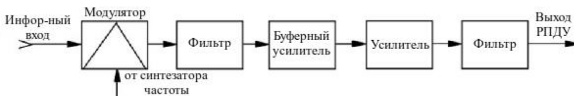
Рисунок 1 – Структура РПДУ с линейным усилением сигналов угловых видов модуляции
