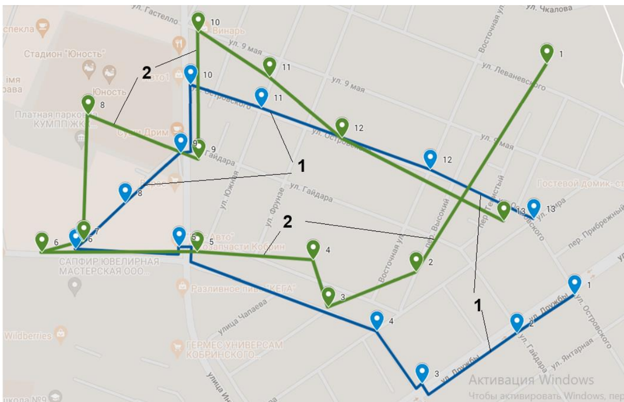
Рисунок 3 – Фактический (1) и построенный по данным позиционирования в сети сотовой связи (2) треки АТ
