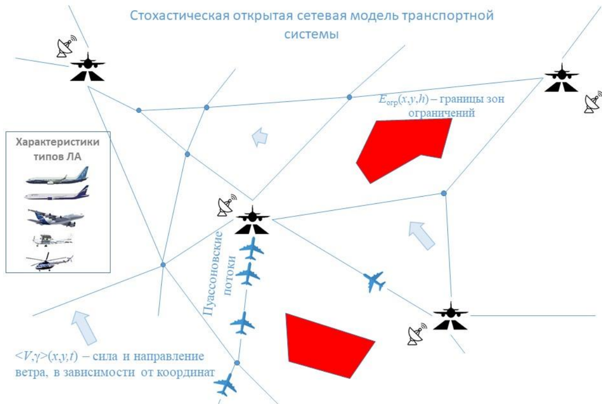
Рисунок 7 – Схема стохастической открытой сетевой модели воздушной обстановки
