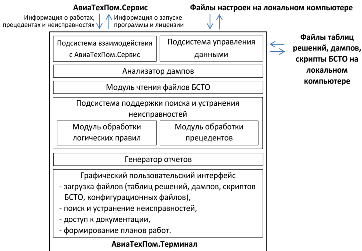
Рисунок 1 – Концептуальная архитектура AviaTechPom.Терминал
