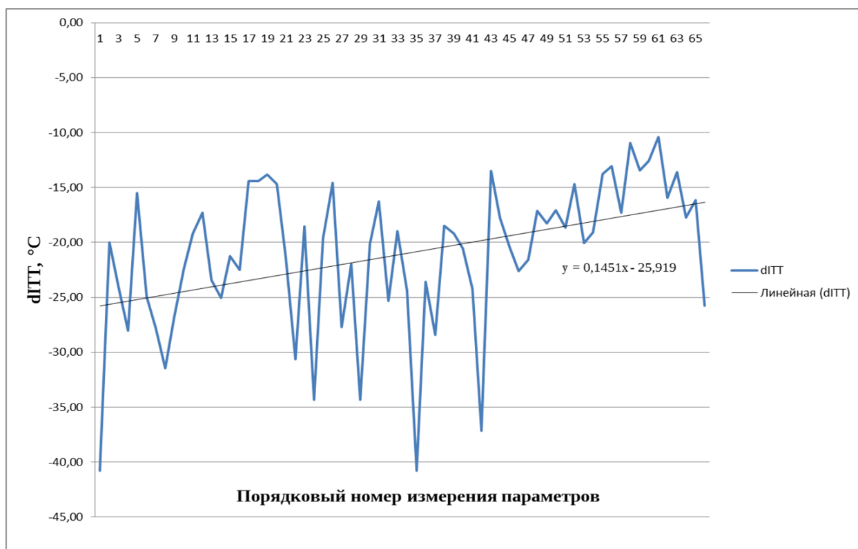
Рисунок 4 – Изменение дифференциальных значений параметра \Delta ITT в ходе измерений
