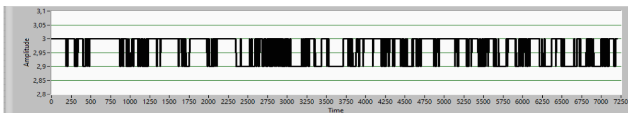
Рисунок 10 – Данные изменения высоты приемником GNSS с лог-файла
