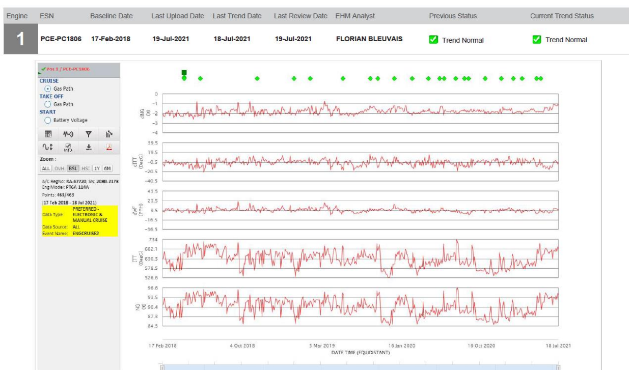
Рисунок 2 – Пример отчета аналитической службы Camp о состоянии двигателя на основании анализа тенденций изменения его параметров
