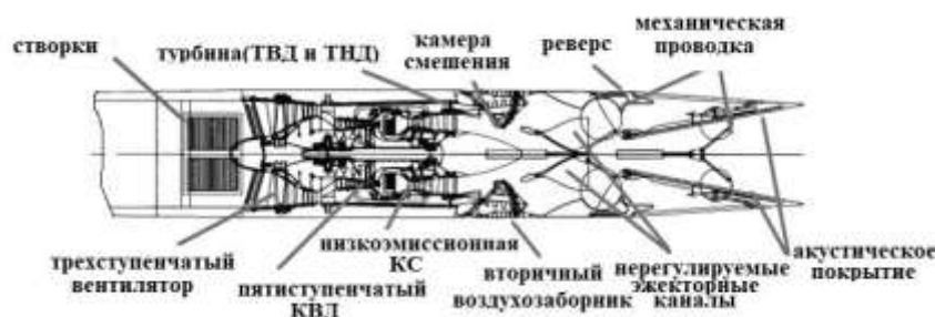
Рисунок 1 – Турбореактивный двухконтурный двигатель с камерой смешения Figure 1 – Turbofan engine with a mixing chamber
