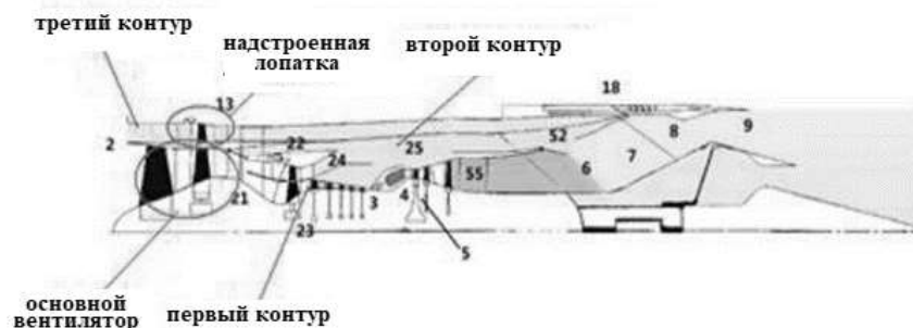
Рисунок 2 – Трёхконтурный двигатель с надстроенной лопаткой второй ступени компрессора низкого давления
