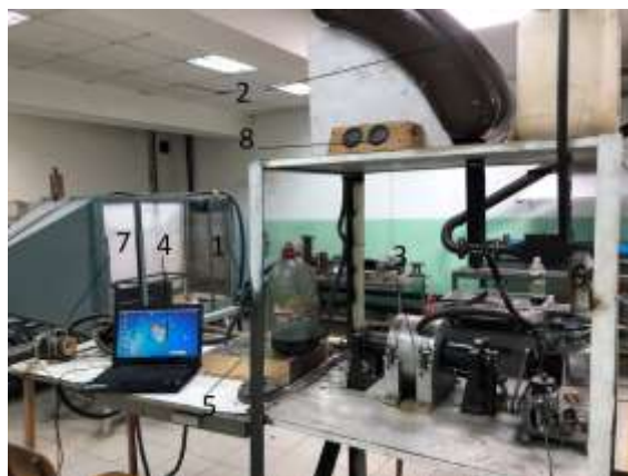
Рисунок 1 – Экспериментальная установка по исследованию характеристик подшипника (1 – станина; 2 – масляный бак; 3 – опора; 4 – система измерения ZetLab; 5 – измерительные модули ZET7121; 6 – насос в магистрали нагнетания; 7 – насос в магистрали откачки; 8 – датчики давления и температуры масла)
