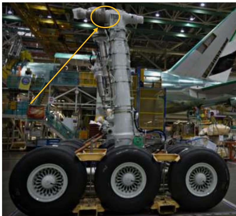
Рисунок 1 – Внешний вид ответной части стойки шасси Boeing 777-300ER,. Источник: https://cz.pinterest.com/pin/boeings-enormous-new-777x-jet-just-took-its-first-flight-take-a-look-back-at-the-history-of-the-companys-largest-twinjet-airplanes--390968811422274353/
