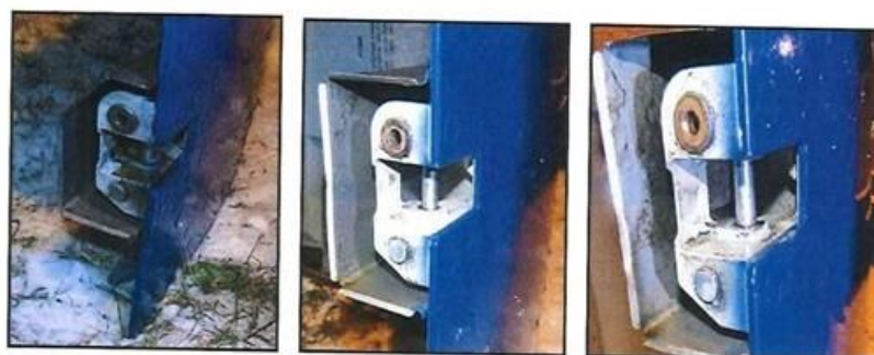
Рисунок 8 – Скобы стяжных замков оторванного капота ВС RA-89112 [Отчет по результатам..., 2020]
