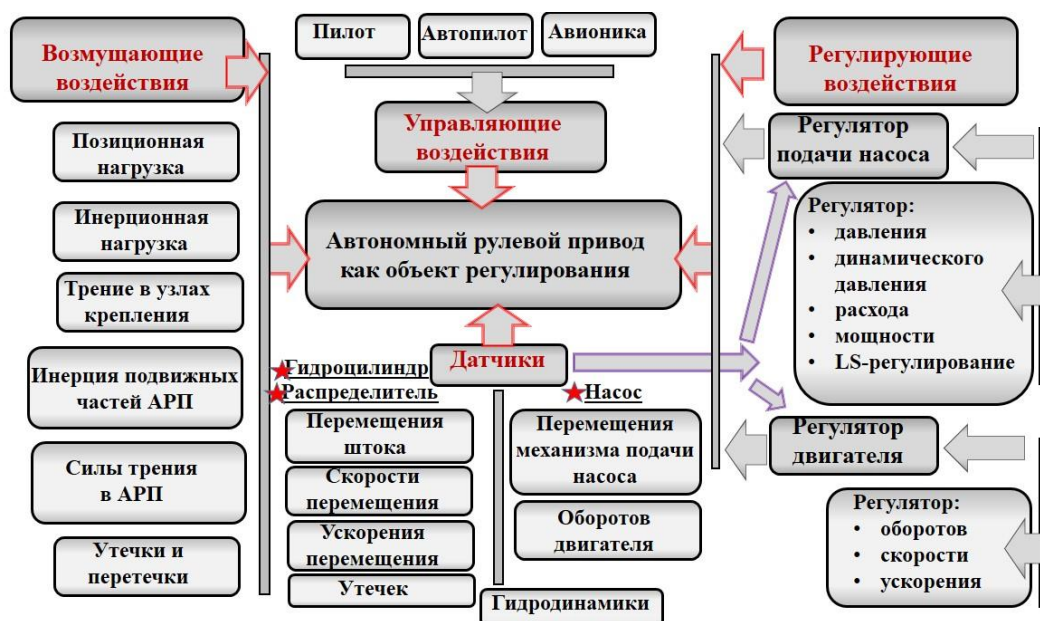
Рисунок 4 – Автономный рулевой привод как объект регулирования Figure 4 – Autonomous flight control actuator as an object of regulation
