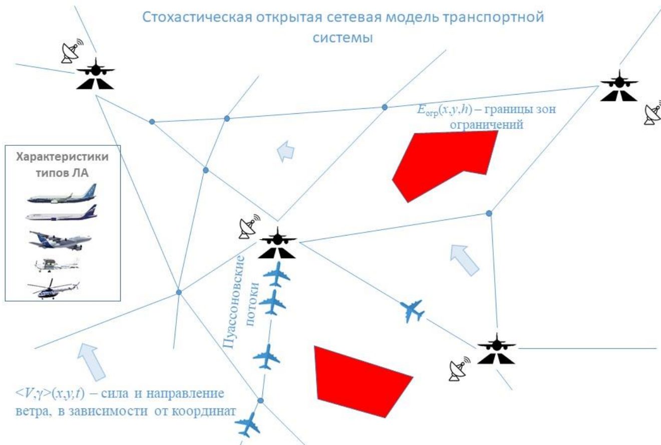
Рисунок 7 – Схема стохастической открытой сетевой модели воздушной обстановки
