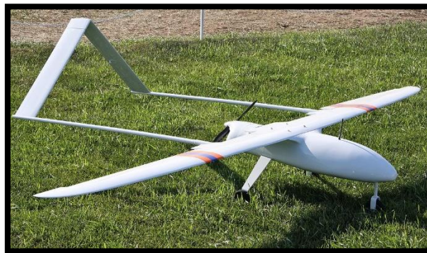
б – обратное V-оперение, толкающий винт;
