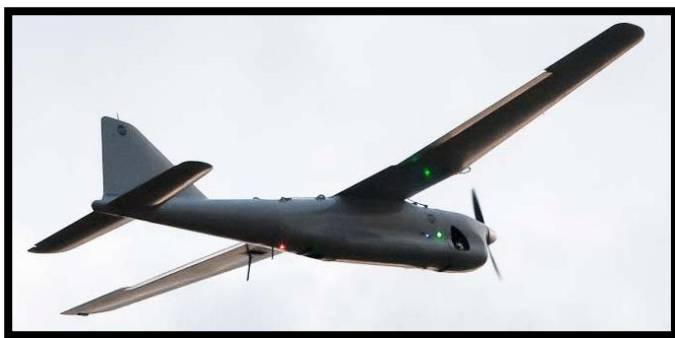
а – высокоплан с классическим оперением;
