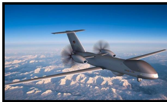
б – низкоплан с Т-образным оперением
