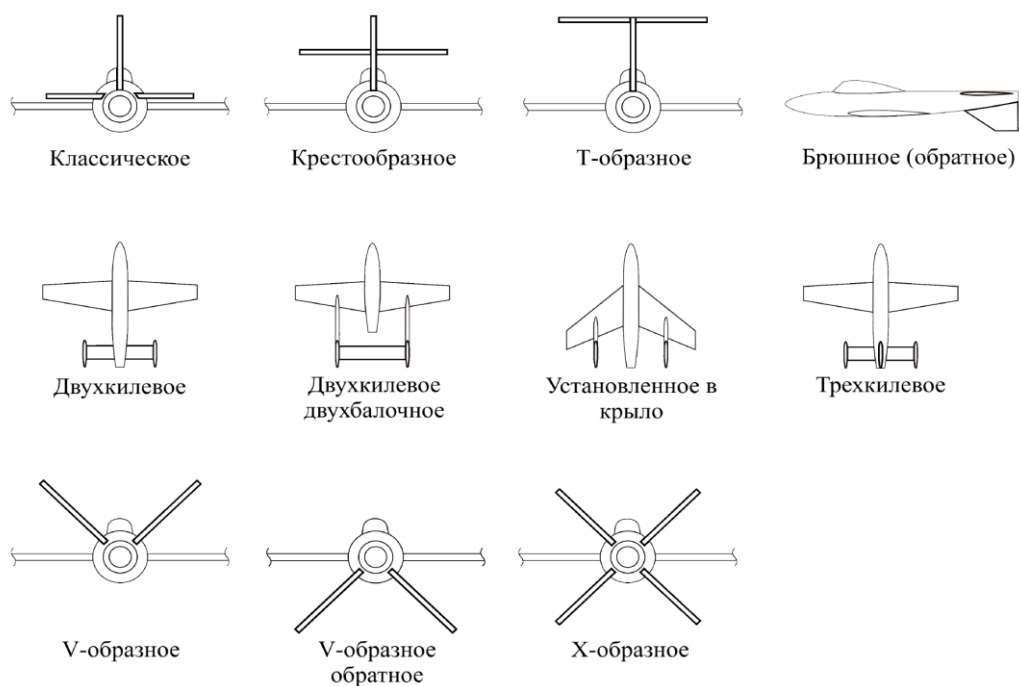
Рисунок 13 – Возможные варианты компоновки хвостового оперения
