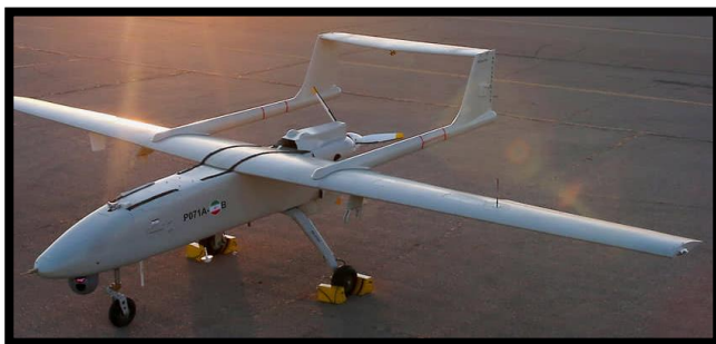
в – П-образное оперение, толкающий винт;
