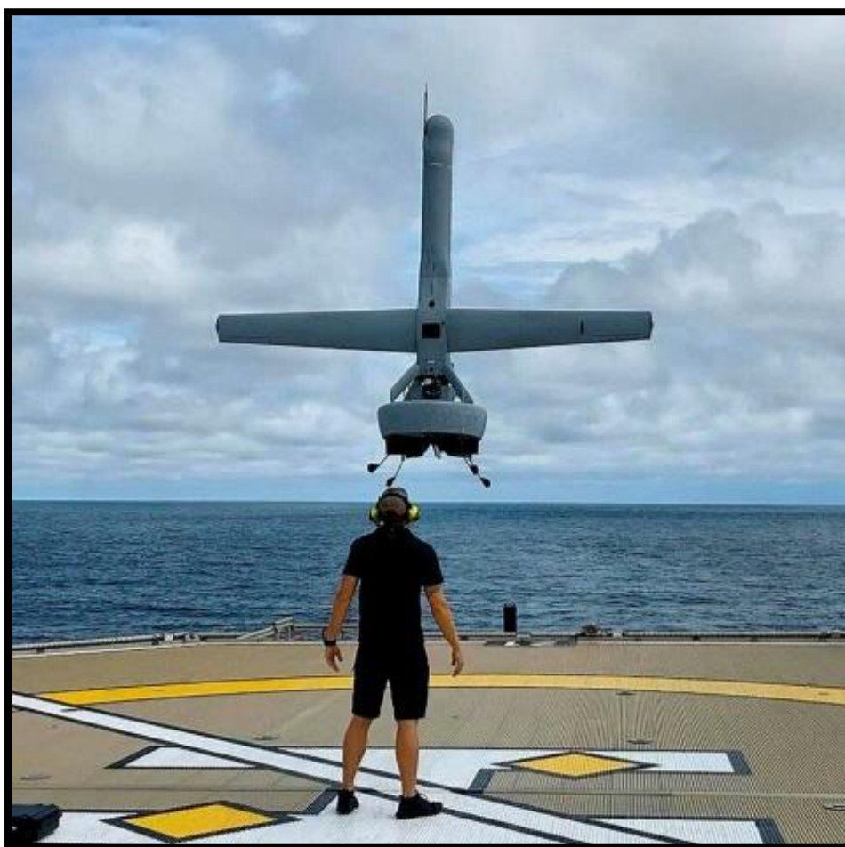
Рисунок 20 – Импеллерный монокоптер с ВВП Martin UAV V-BAT. Источник: https://goo.su/q7mMj
