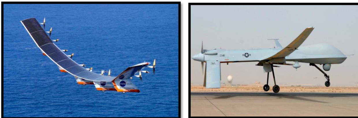
Рисунок 18 – Прогиб упругого крыла большого удлинения как ожидаемое условие при лётной эксплуатации БВС.
