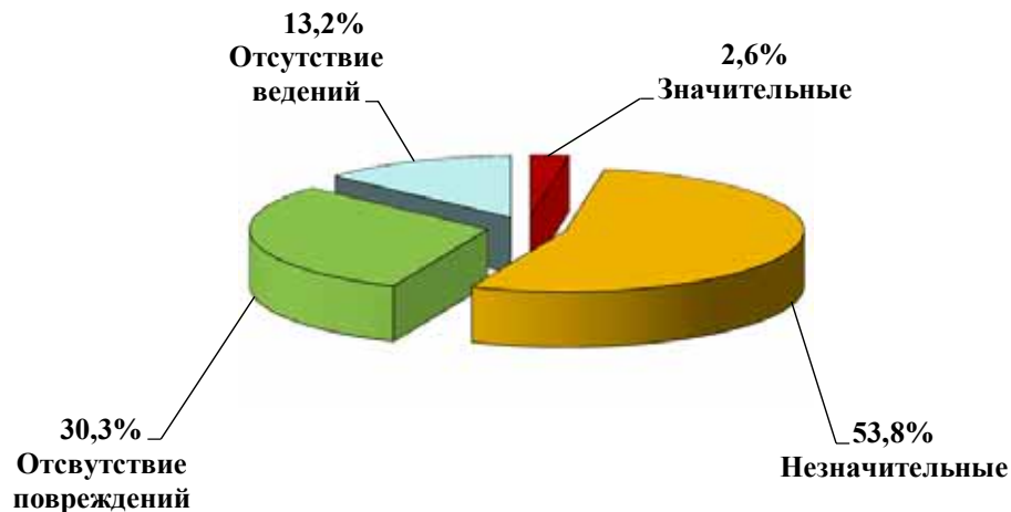
Рисунок 4 – Структура повреждений ВС вследствие ударов обломков шин
