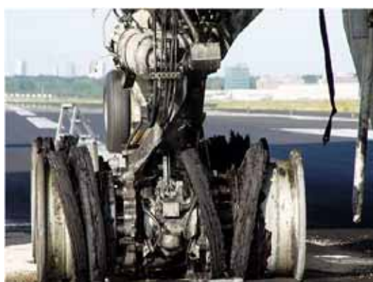
Рисунок 2 – Последствия разрушения пневматика [rikabu.ru]
