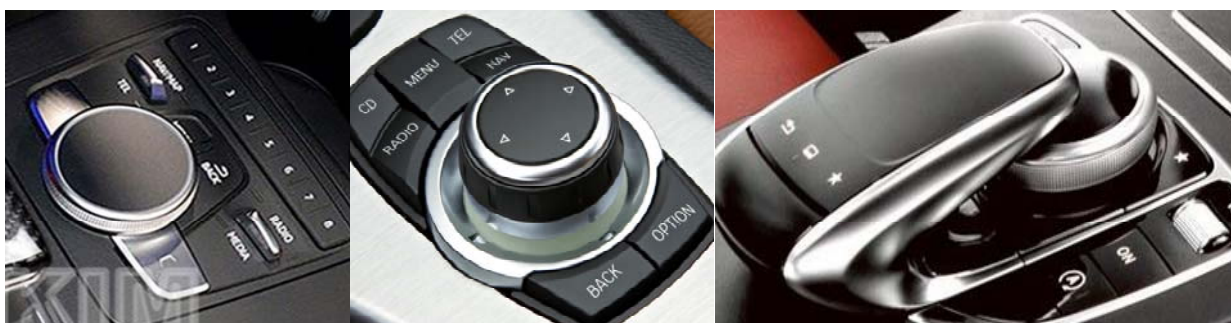
Рисунок 5 – Панели управления типа «Rotary Knob», применяемые в автомобильной промышленности
