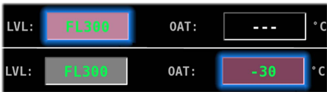
Рисунок 10 – Управление меню навигационного дисплея и зоной текстовых сообщений
