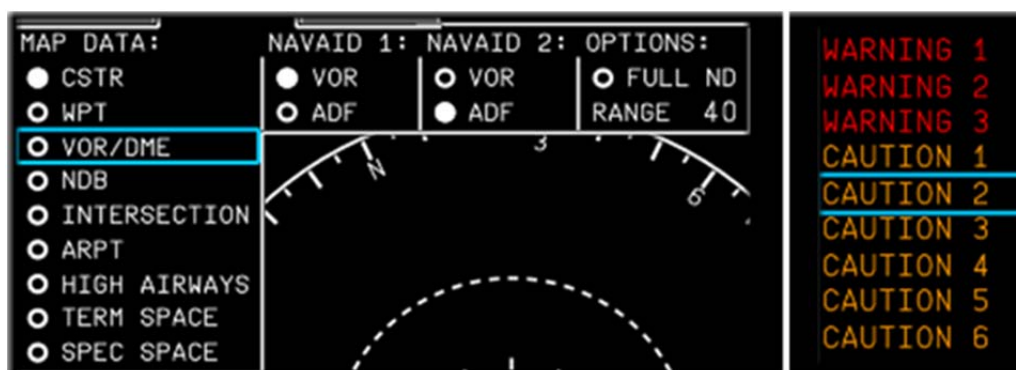
Рисунок 9 – Управление меню навигационного дисплея и зоной текстовых сообщений
