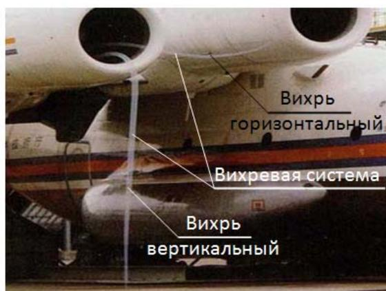
Рисунок 7 – Вихревая система ГТСУ ВС
