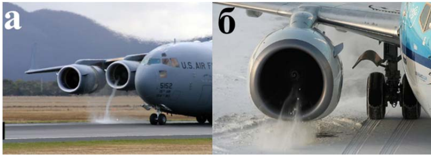
Рисунок 5 – Сравнение вихрей при высоком (а) и низком (б) расположении воздухозаборника авиационного двигателя над поверхностью аэродрома
