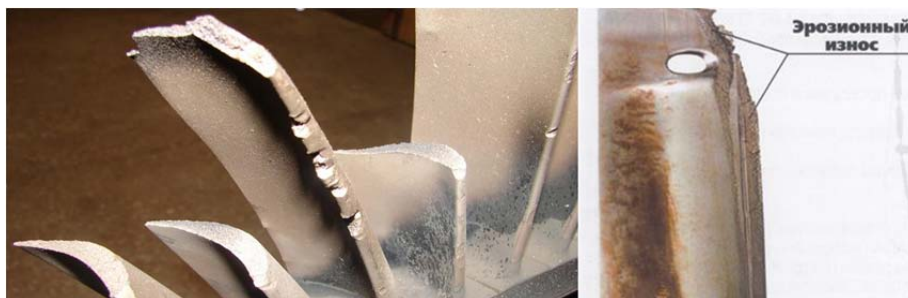
Рисунок 6 – Эрозионный износ лопаток компрессора мелкими посторонними предметами и частицами песка и пыли
