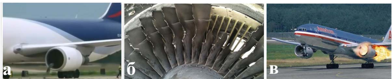
а – вихревое засасывание посторонних предметов и персонала; б – повреждение лопаток компрессора двигателя; в – помпаж ТРДД
