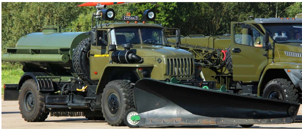
Рисунок 8 – Уборочные машины современной аэродромной техники
