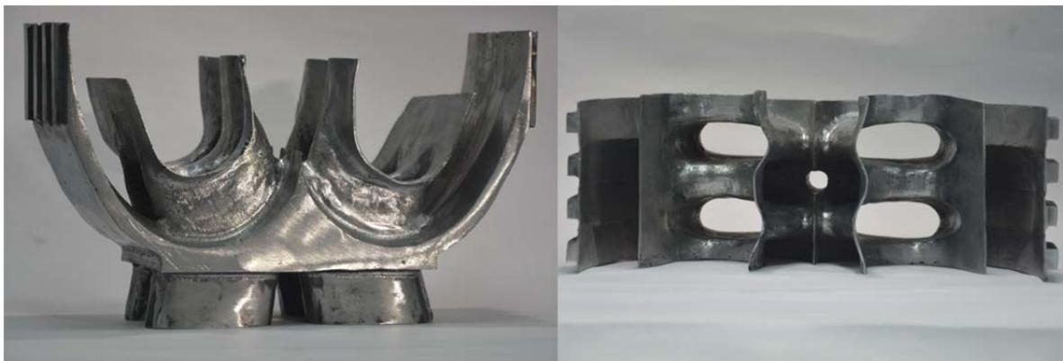
Рисунок 7 – Выходная часть камеры сгорания с поперечной системой образования зон обратных токов, включающая в себя коллектор газового потока
