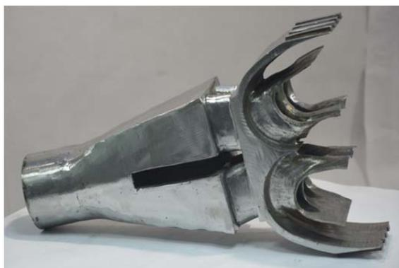
Рисунок 8 – Коллектор газового потока, объединённый с газосборником в единую конструкцию
