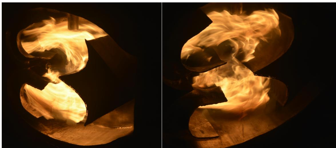
Рисунок 10 – Процесс горения в камере сгорания с поперечной системой образования зон обратных токов
