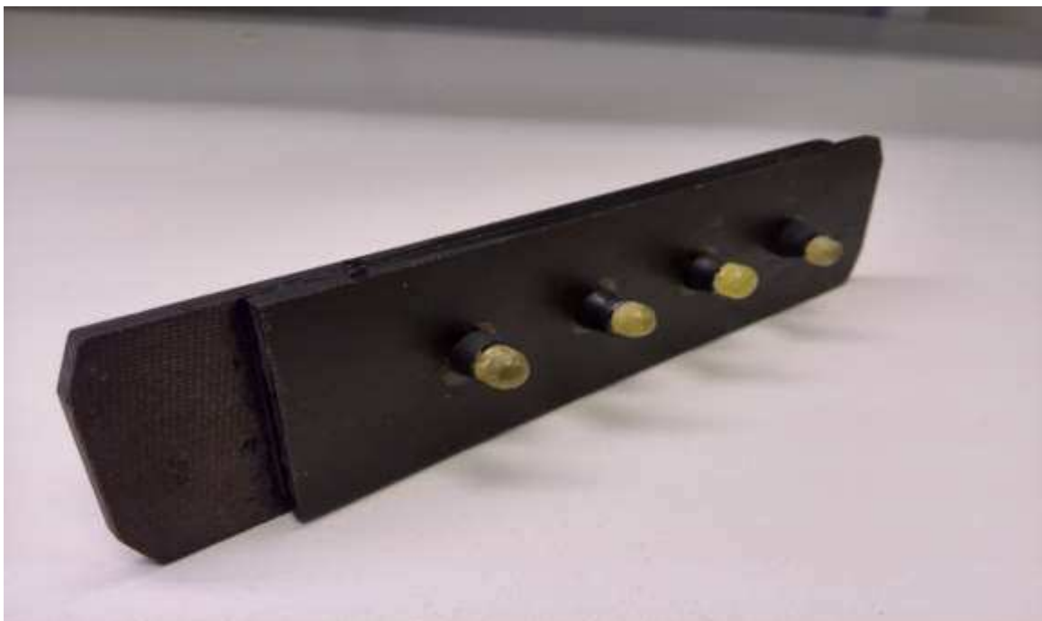
Рис. 9. Постадийное формообразование замыкающей головки заклепки для производства и ремонта агрегатов планера из ПКМ при отсутствии двухстороннего подхода к заклепочному шву
