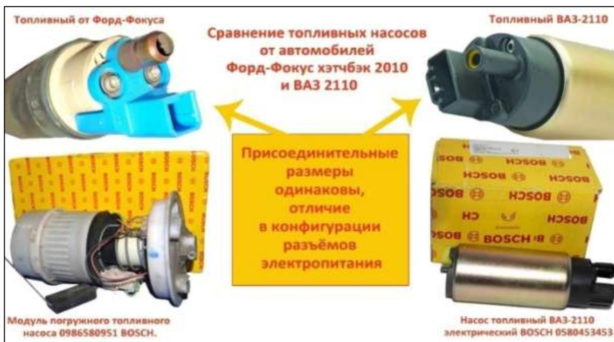
Данную тему можно применять и для современных моделей. Например, к автомобилю «Форд-Фокус» хэтчбек 2010г. топливный насос подходит от ВАЗ-2110.
