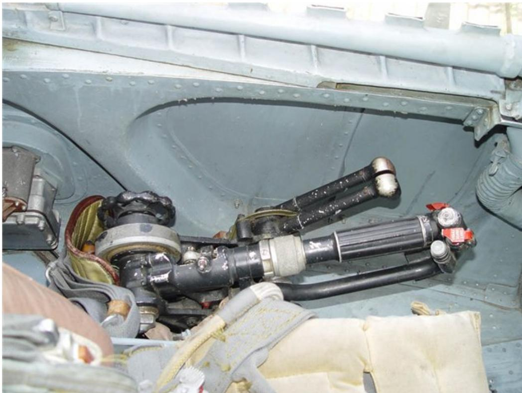
Рисунок 10 – Внешний вид ручки Шаг-Газ
