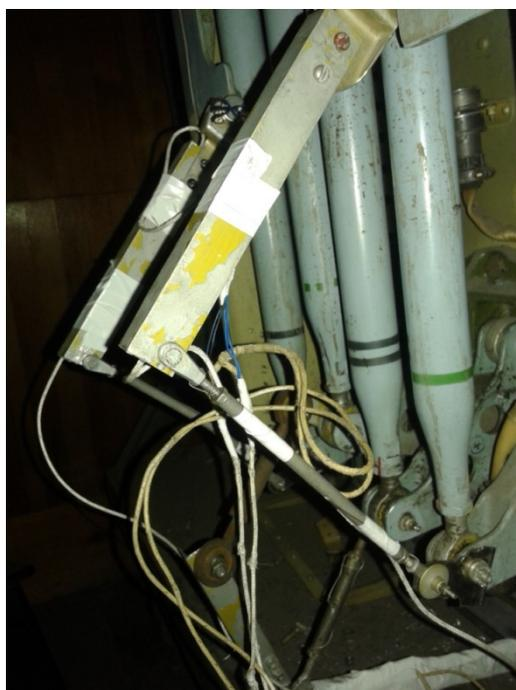
Рисунок 13 – Техническая реализация подключения потенциометров к тягам
