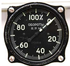
Рисунок 15 – Внешний вид указателя двухстрелочного тахометра ИТЭ-2
