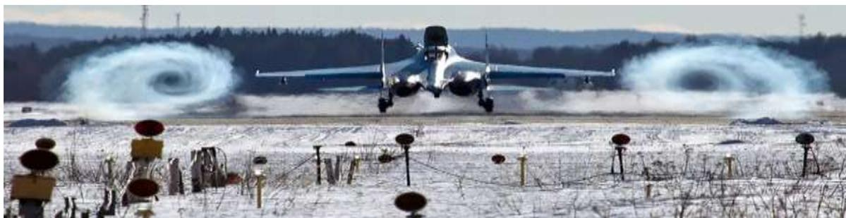
*Рис. 2.* Концевые вихри ВС – следствие циркуляционного обтекания его крыла
