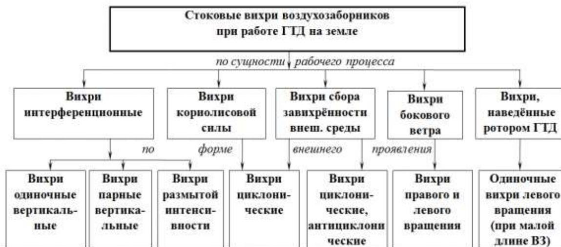
Рис. 1. Классификация вихрей ВЗ по сущности рабочего процесса и внешнего проявления.
